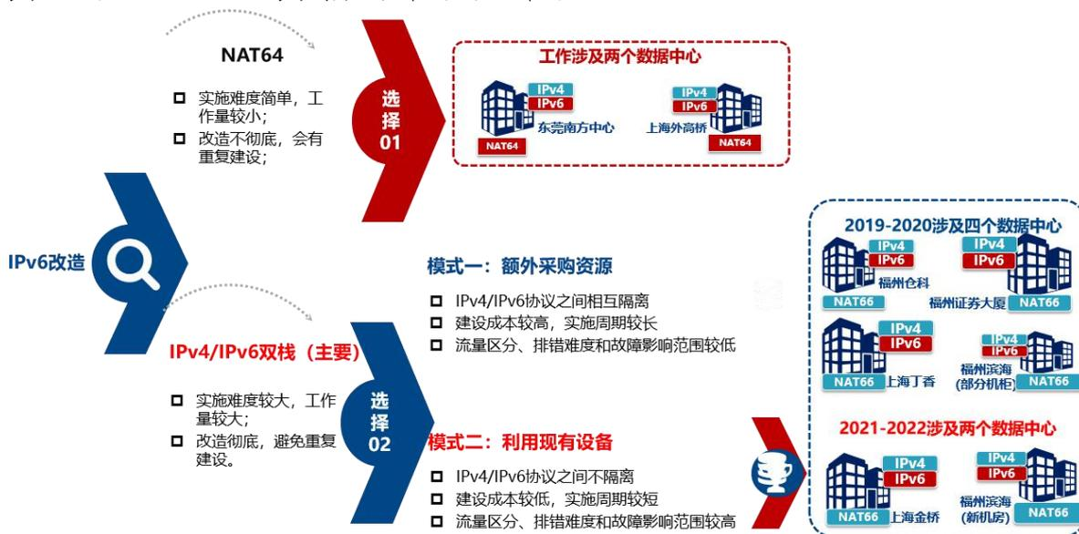
图 1 IPv6 改造技术选型
